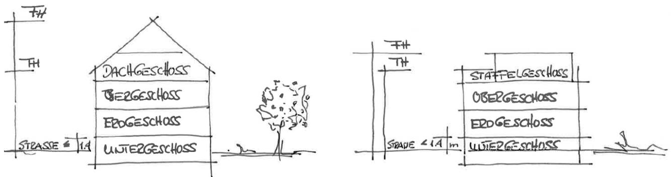
Das Dachgeschoss und das Staffelgeschoss sind in der Schemaskizze jeweils keine Vollgeschosse. Staffelgeschosse müssen bei den äußeren Fassadenteilen umlaufend um min. 0,30 m gegenüber dem darunter liegenden Geschoss zurückgesetzt werden. Dies gilt nicht bei Reihen- und Doppelhäusern die an einer gemeinsamen Grenze errichtet werden.
