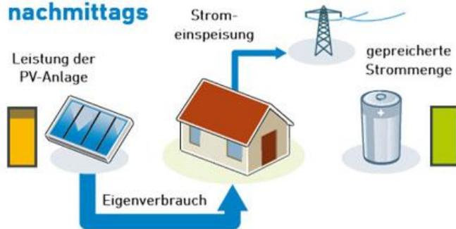
Wenn die Hausbewohner am Nachmittag wieder Strom benötigen, ist der Speicher voll geladen. Da die PV-Anlage noch einen großen Teil ihrer Leistung liefert, kann der Bedarf durch Eigenverbrauch voll gedeckt werden. Der darüber hinaus erzeugte Solarstrom wird ins Netz eingespeist.
